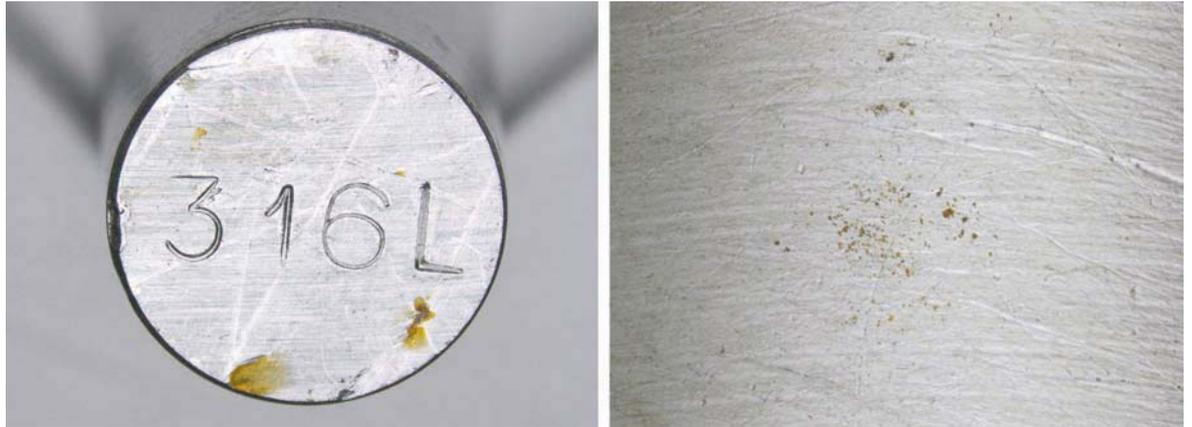
Fig. 2. Exemple de corrosion inattendue sur le bout (à gauche) et le flanc (à droite) d'un échantillon d'acier inoxydable de type 316L; échantillon non passivé, test au brouillard salin.
