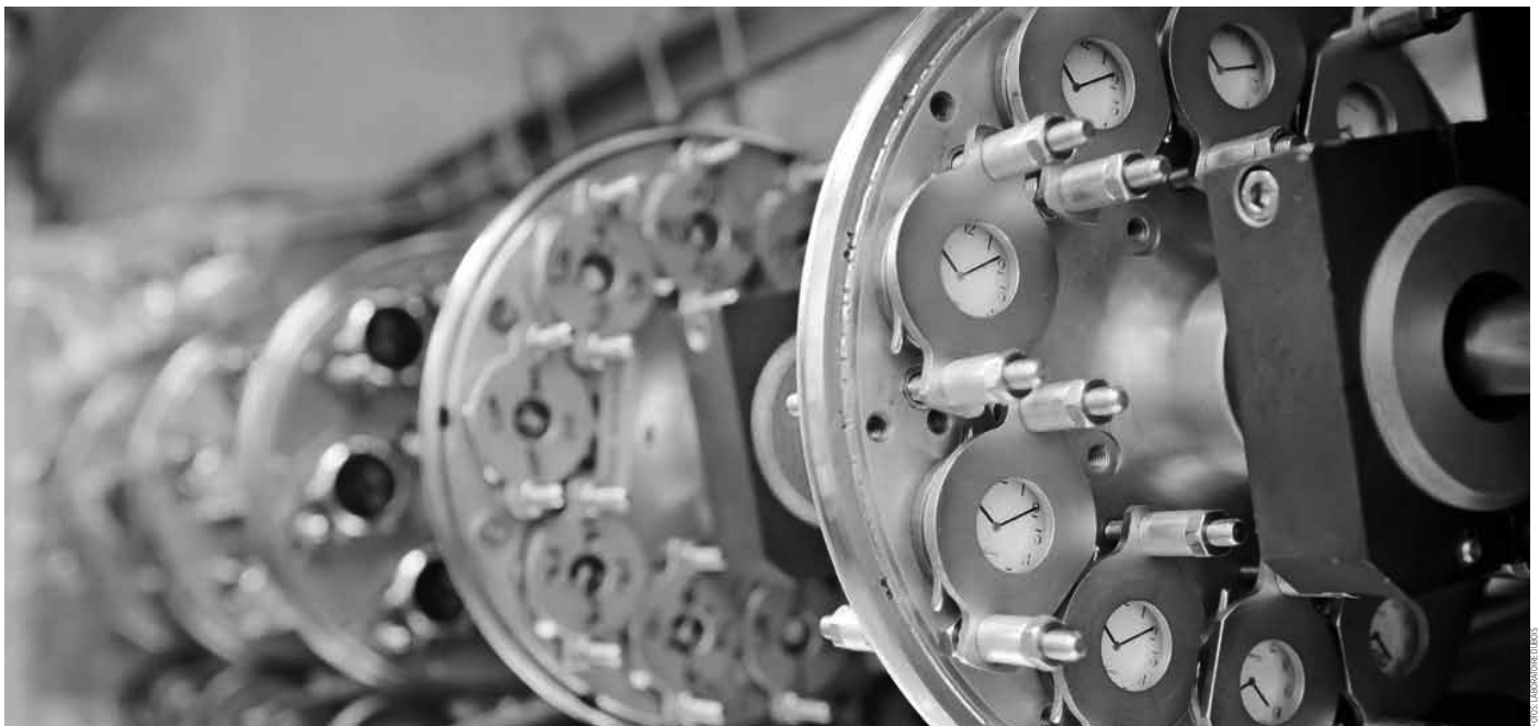
Uhren-Folterkammer: Die Testmaschine von Chronofiable simuliert in 21 Tagen bei den eingespannten Uhren eine sechsmonatige Dauerbelastung. Simuliert wird nicht das Tragen, sondern dessen Auswirkungen.
