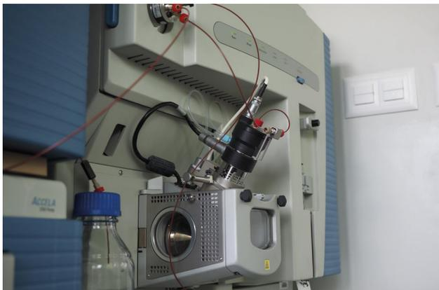
Fig. 2: Equipement de chromatographie HPLC-MS utilisé pour l'analyse des amines aromatiques.
