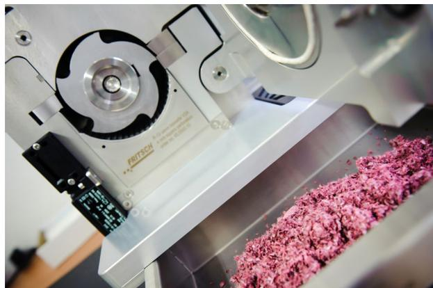
Fig. 1 : Broyage d'un bracelet avant analyses chimiques.
