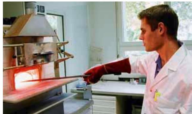
*Pour une analyse plus précise, l'échantillon de métal précieux sera d'abord pesé, puis coupillé dans un four.*
