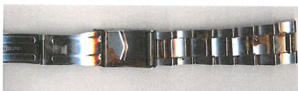
Essai au brouillard salin sur boîtes de montre.
