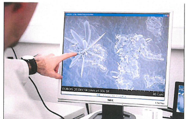
Aiguilles de sulfure d'argent à la surface d'un cadran.
