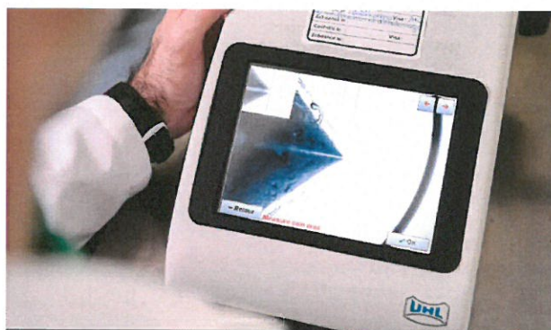
Empreinte Vickers sous une charge de 2 kgf.
