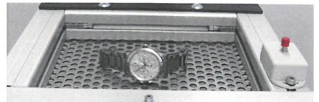
Test de chute libre sur montre complète
