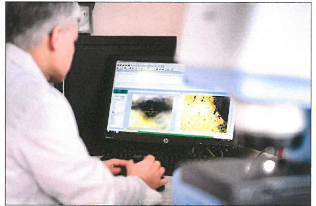
Analyse d'un dépôt de polymère fluoré sur une surface métallique, polie. Cartographie chimique d'un dépôt.
