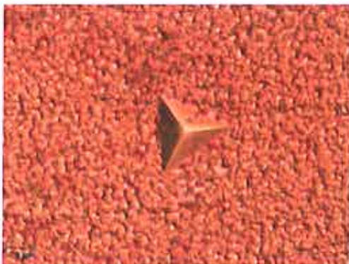
Exemple d'une empreinte réalisée sur un revêtement galvanique de cuivre brut de déposition avec une charge de 100 mN.
